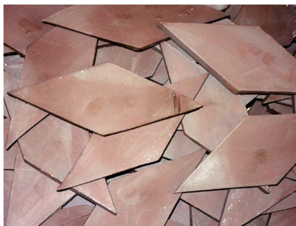
Détail de pièces en cours de production, 2015 Dalles en grès en attente de cuisson
